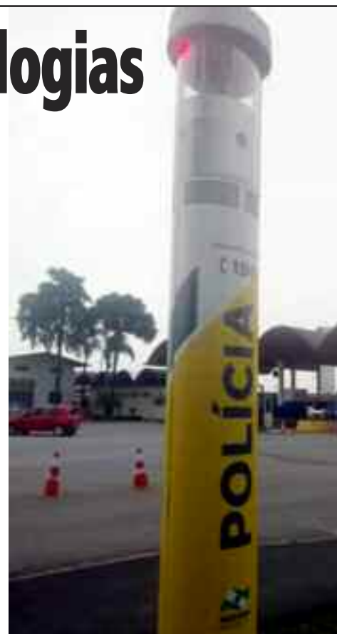
O totem de 4 metros de altura é dotado de câmera com giro de 360 graus, zoom de imagem, visão noturna e uma mensagem automática de viva voz com sensor de aproximação. Também reconhece placa de veículo roubado, incluindo giroflex, sirene e botão de acionamento para o 190 de emergência
